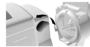
2. Bedienteil auf Ventilaufsatz stecken und bis zum Anschlag aufschieben. Die ebene Fläche des Ventilaufsatzes muss mit dem Bedienteil bündig abschließen.
